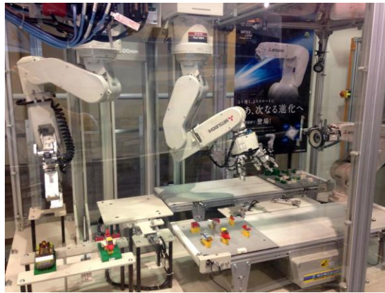
展示的三台机器人协同完成高难度的部件组装
